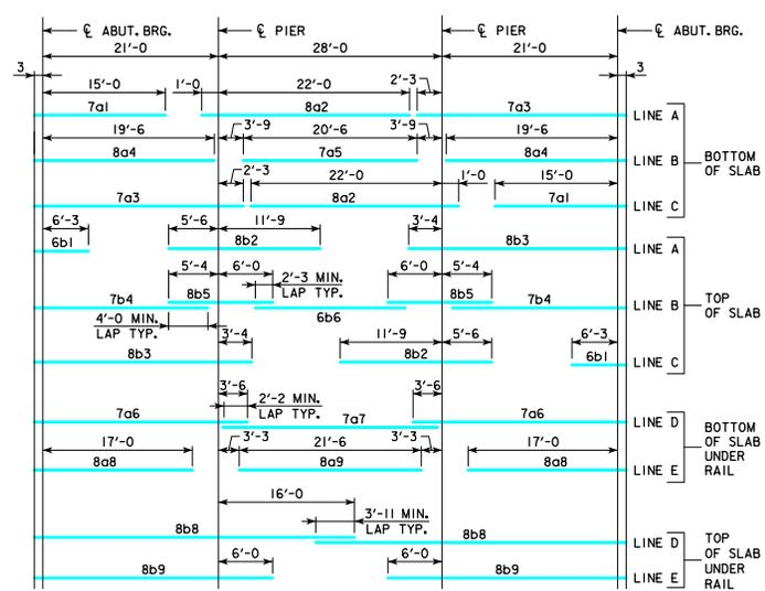
**PLACEMENT FOR LONGITUDINAL REINFORCEMENT**
