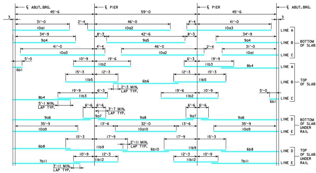
**PLACEMENT FOR LONGITUDINAL REINFORCEMENT**
