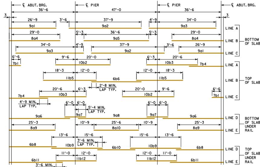
**PLACEMENT FOR LONGITUDINAL REINFORCEMENT**
