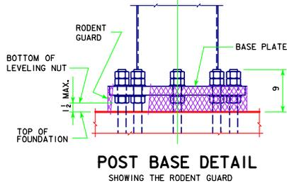
THE RODENT GUARD SHALL BE PLACED AROUND THE BASE PLATE.
