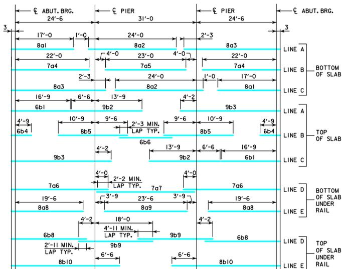
**PLACEMENT FOR LONGITUDINAL REINFORCEMENT**
