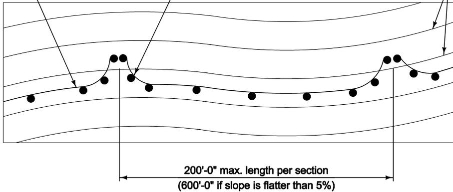
**TYPICAL SILT FENCE INSTALLATION ON LONGITUDINAL SLOPES**
