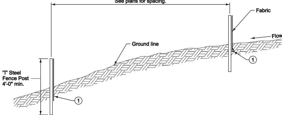
**TYPICAL SILT FENCE INSTALLATION ON LONGITUDINAL SLOPES**
