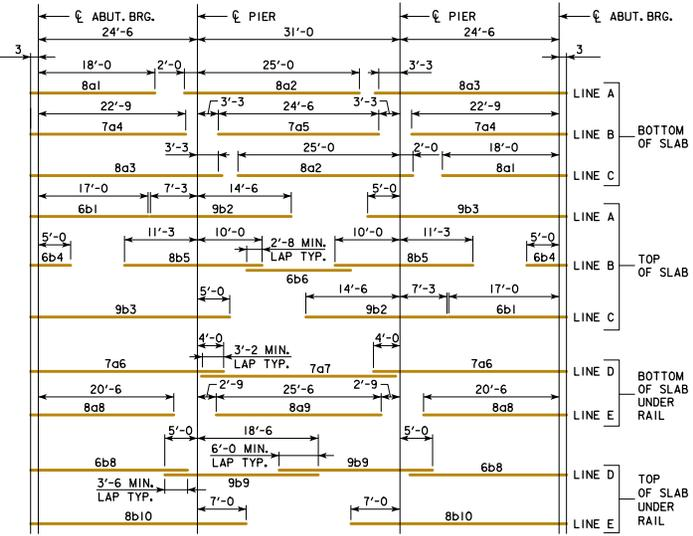
**PLACEMENT FOR LONGITUDINAL REINFORCEMENT**
