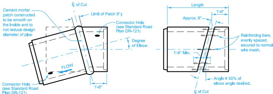
TYPICAL CONCRETE PIPE ELBOW
