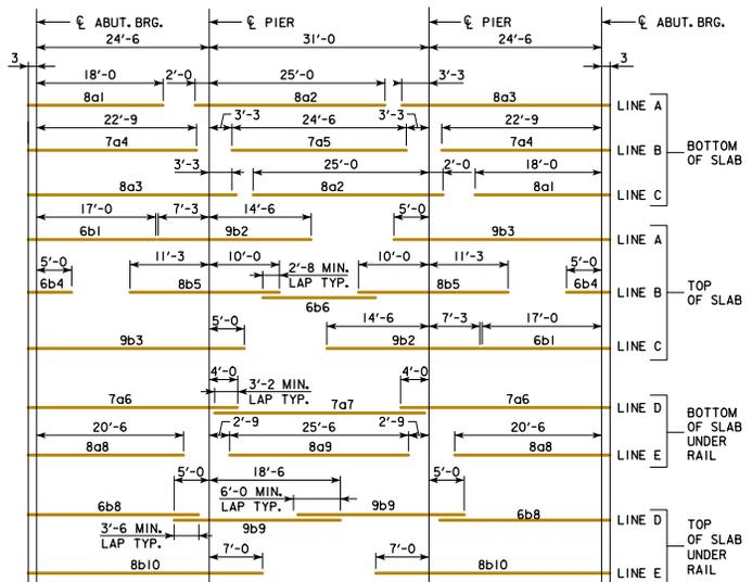
**PLACEMENT FOR LONGITUDINAL REINFORCEMENT**
