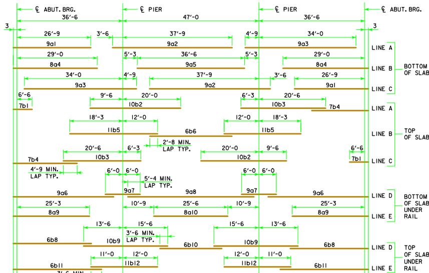
**PLACEMENT FOR LONGITUDINAL REINFORCEMENT**
