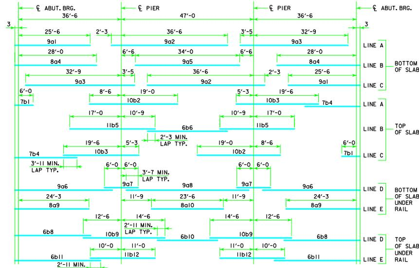
**PLACEMENT FOR LONGITUDINAL REINFORCEMENT**
